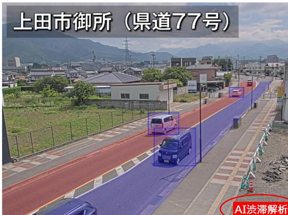
【混雑・渋滞発生時】車線上の車の速度（滞在時間）を測定し、渋滞が発生している車線について画面上に「渋滞」と文字表示されます。
